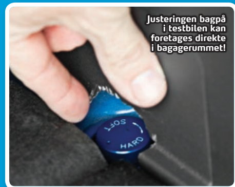
Start med at stille støddæmperne i f.eks. trin 10 og derefter i trin 0
