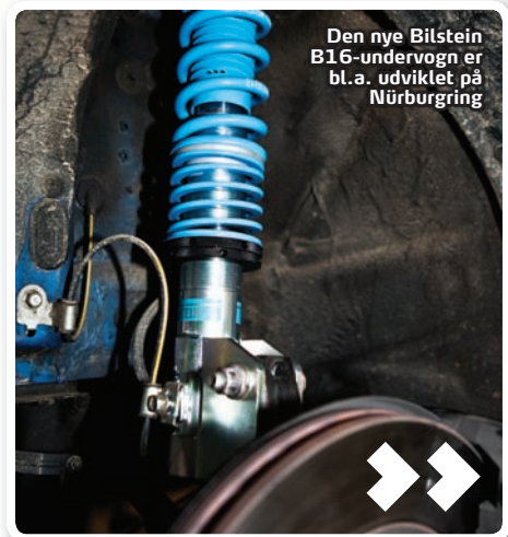
Ved monteringen er det vigtigt, at hjulvinklerne forbliver rigtige. Cambervinklerne kan nemt ændres
