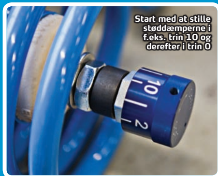
Foran foregår justeringen på en stor drejeknap i bunden af støddæmperen
