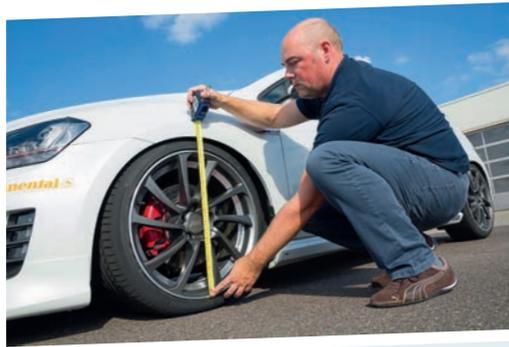
**Anhand der Serienstandhöhe wurde nach den Test-fahrten die erzielte Tieferlegung gemessen. Con-tinental stellte für jedes Fahrwerk einen Satz Conti-ForceContact zur Verfügung, Abt die 19-Zöller**
