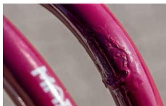
**Qualitätsmängel im Detail: Supersport (links) fällt mit wackeliger Federaufnahme auf, eine der Vogtland-Federn (oben) wies Fehler in der Beschichtung auf. Nach den Tests fanden wir besonders starken Lackschwund bei Supersport und Lowtec (unten). Lowtecs Federbein mit sehr langem und unbehandeltem Gewinde**
